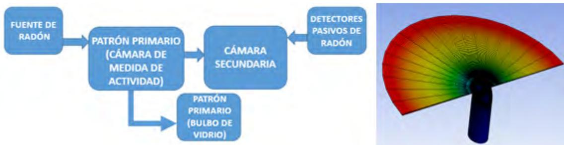
Esquema del laboratorio de metrología de radón (arriba) y simulación del gradiente térmico en la base de la cámara de medida (abajo).
