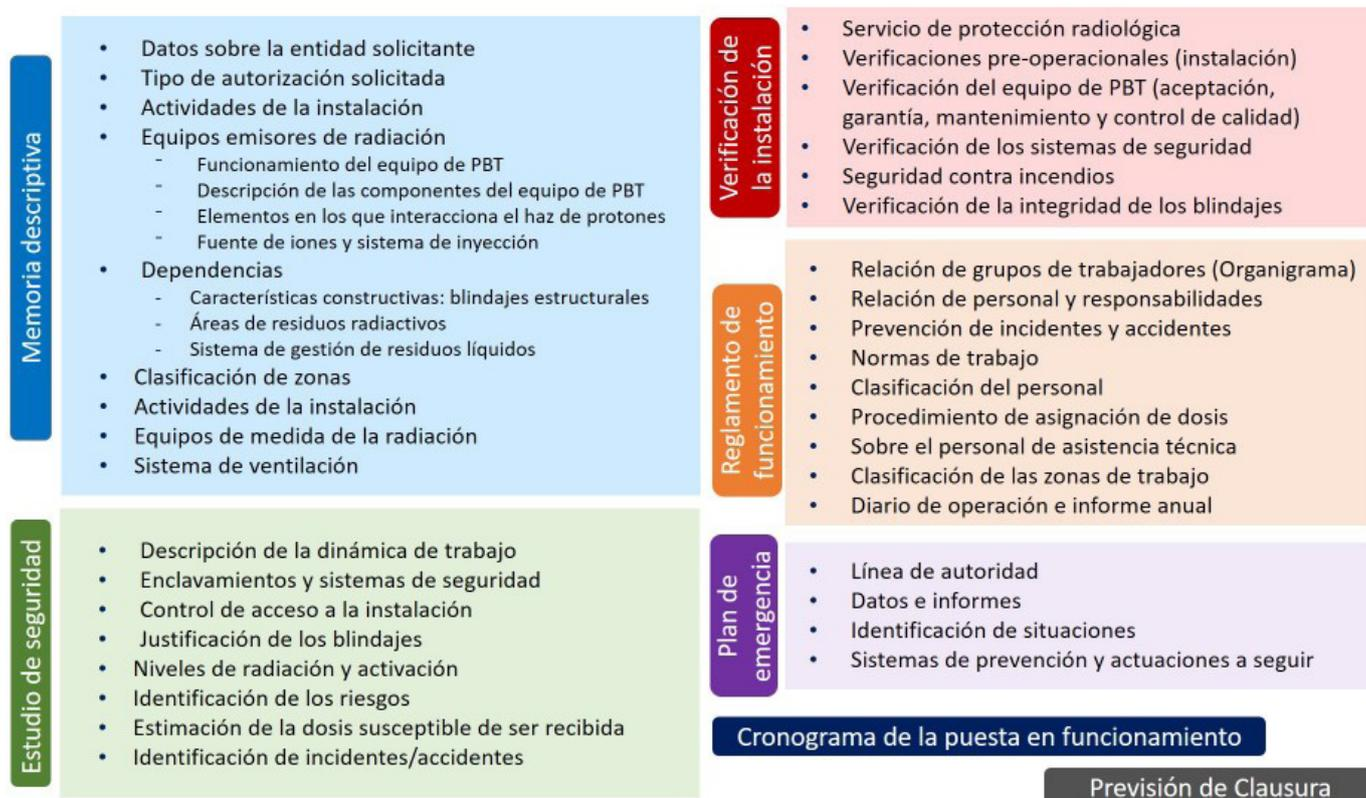
Figura 1. Esquema del contenido de la memoria de la instalación
