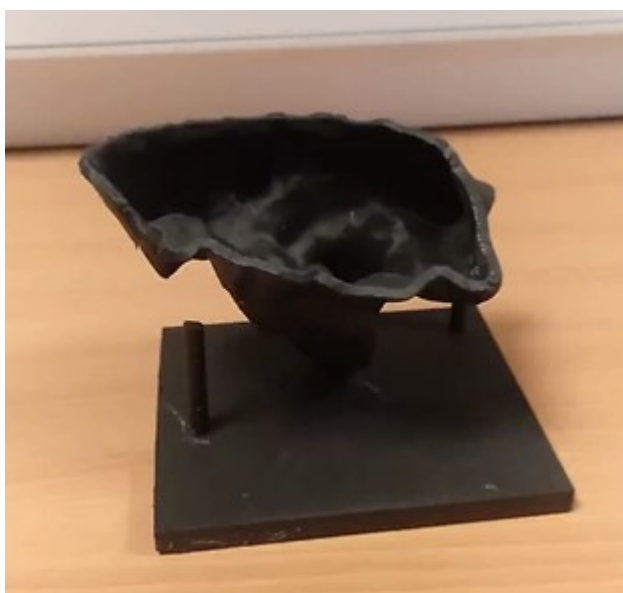
Figure 44: Fig 2. Modelo impreso para un sarcoma en la cavidad abdominal. Sobre este modelo es posible simular el tratamiento para estimar la dosis mediante el uso de película radiocrómica.
