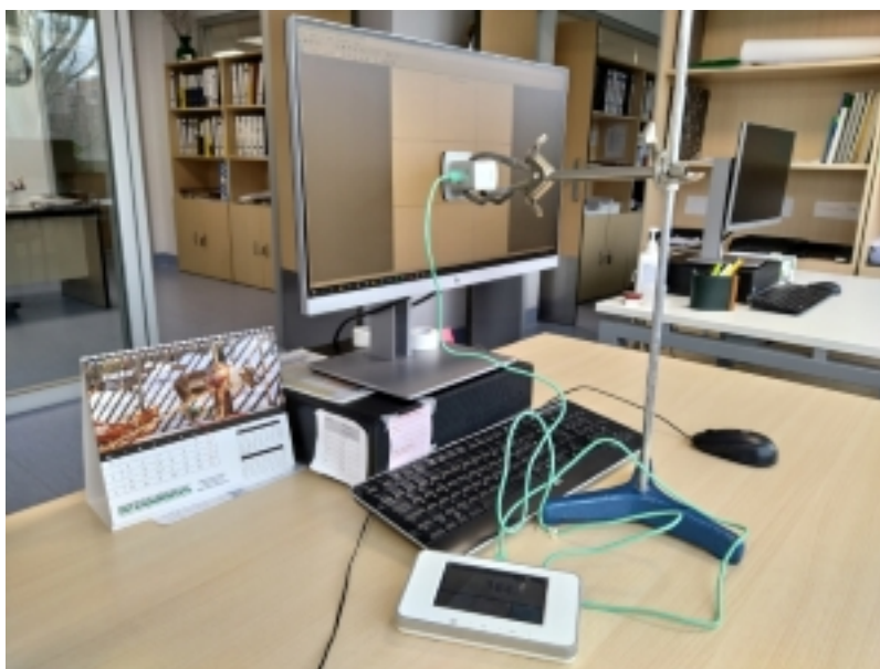
Figure 450: Montaje experimental empleado para las medidas fotométricas.
