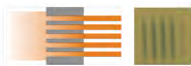
Figura 1. Izquierda. Esquema del colimador usado para generar los minihaces. Derecha. Película radiocrómica que muestra el patrón de picos y valles obtenido en este tipo de técnicas de radiación espacialmente fraccionada.
