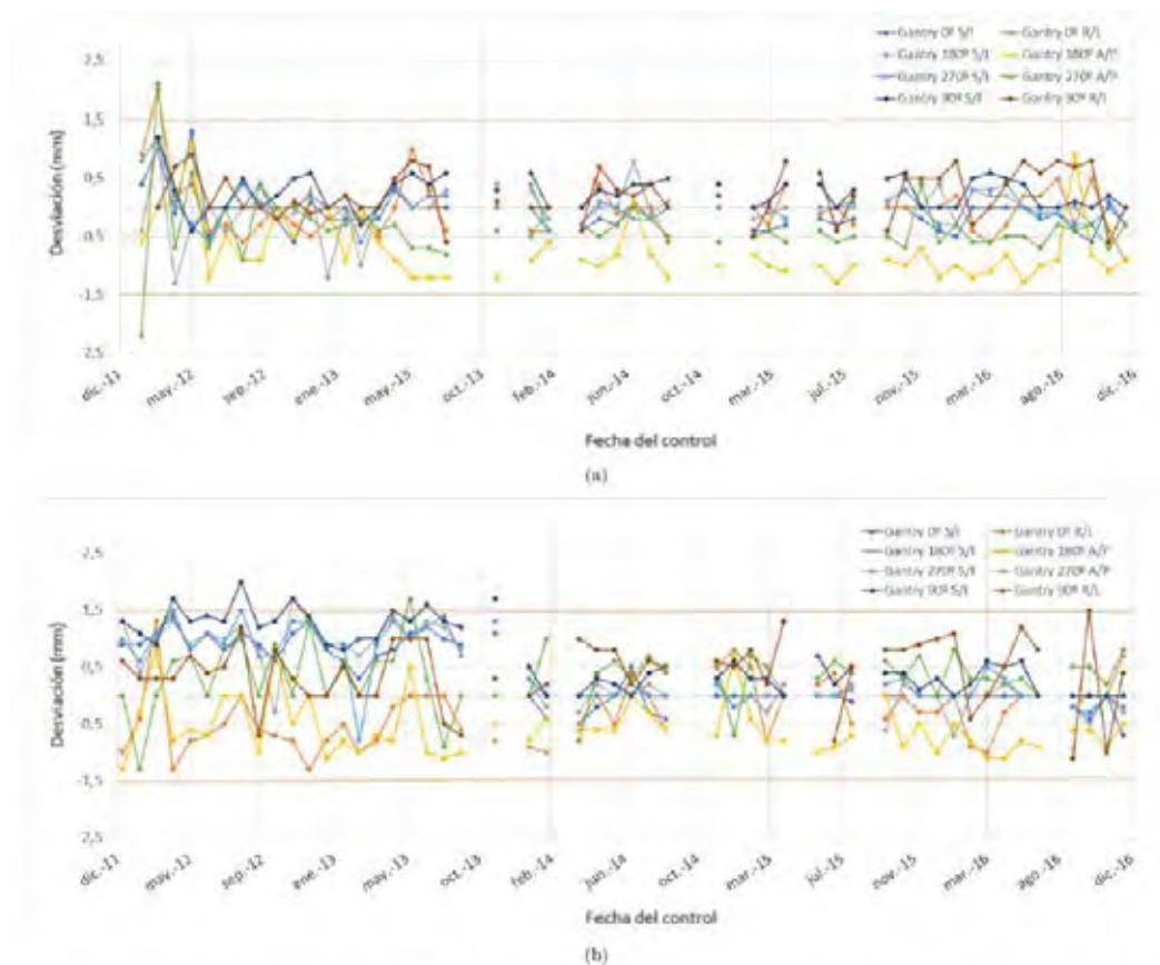
Evolución temporal del isocentro de los sistemas de imagen On-Board Imager (OBI) (a) y Electronic Portal Imaging Device (EPID) (b) del Varian Clinac 2100 n° 1. Los signos positivos indican desplazamientos en los sentidos S (superior), A (anterior) y R (derecha) en cada una de las direcciones de angulación del gantry. Se marca con una línea naranja las tolerancias establecidas.
