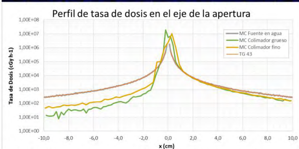
Fig. 2.- (Sup.) Distribución de la tasa de dosis del plano perpendicular z=0 en un mapa bidimensional para el aplicador grueso, con isodosis de 100, 200, 300, 500, 1000, 5000 y 10000 cGy h-1. (Inf.) Perfil de tasa de dosis para el colimador fino y grueso en el eje
